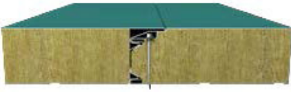
Gizli Vida Cephe Paneli Birleşim Detayı Hidden Screw Wall Panel Connection Detail
