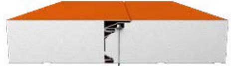
Gizli Vida Cephe Paneli Birleşim Detayı Hidden Screw Wall Panel Connection Detail
